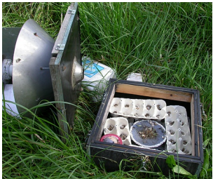
Undir sterkri ljósaperu er stór málmtrékt sem liggur niður í safnkassa. Í kassanum er svæfingarefni sem tryggir að fiðrildin sleppi ekki úr gildrunni. Minni trékt í kassanum leiðir regnvatn í gegn. Eggjabakkar auka yfirborð fyrir fiðrildin að setjast á og róast.
