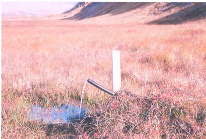
3. ljósmynd. Lind við rætur Litlaskarðsfjalls. Vatn er tekið úr lindinni mánaðar- lega til efnagrein- ingar. Vatnið er leitt úr lindinni um rör til að auð- velda sýnatöku á vetrum. Ljós. Sigurður H. Magnússon, 1/10 1998.
