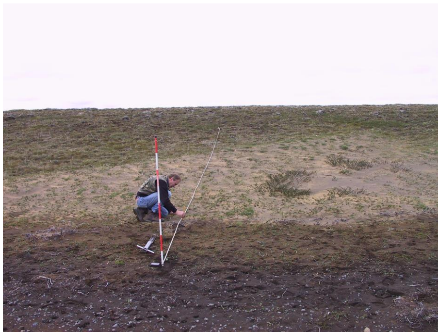
15. mynd. Sandur sem fauk upp í Sandvík sumarið 2003 og myndaði þar lítinn geira. Hér er verið að mæla sandþykktina á einu af þremur sniðum sem var lagt upp eftir geiranum. Flatarmál svæðisins var 0,19 ha, meðalsandþykkt 7,4 cm og sandmagn rúmir 50 m 3 . (Ljósm. B.M., 22. ágúst 2003).
