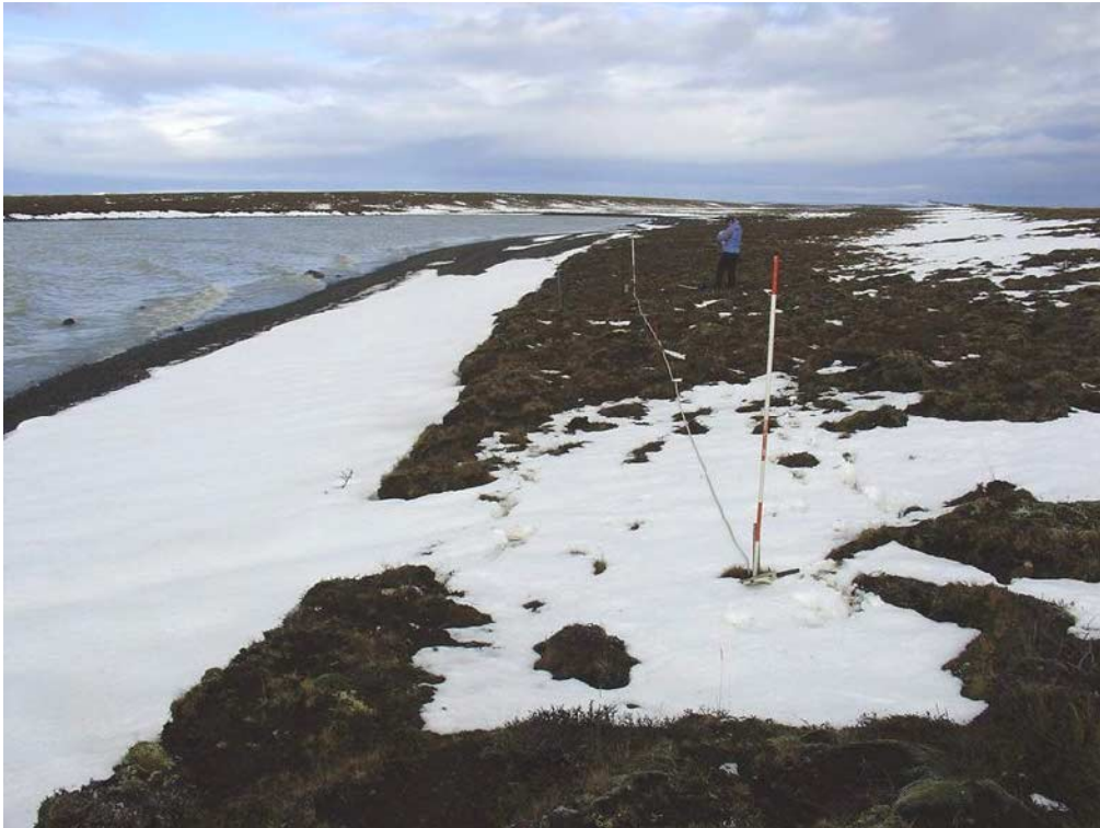
12. mynd. Frá sniði R 0 (gróðursnið 3), 4. október 2005, vatnsborðshæð 477,7. Malarfjara hefur hér myndast neðan bakka en hæð hans á sniðinu er á bilinu 50–100 cm. Rof úr bakkanum mældist 0,11 m frá september 2004 til október 2005. (Ljósm. B.M.).
