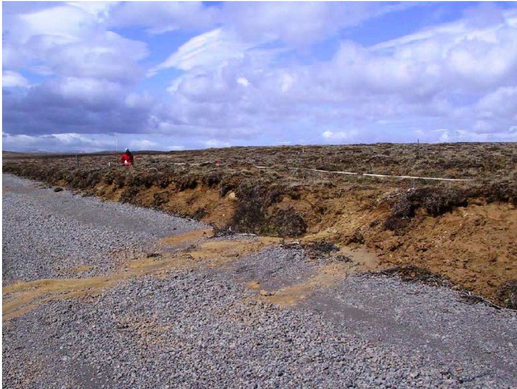
17. mynd. Rof úr bökkum Blöndulóns fyrir áhrif frosts og þíðu, snið R 0. Hér hefur myndast malar-kambur í fjöru sem ver bakkann fyrir öldu, en efni losnar úr bakkanum þegar frost fer úr jörðu. Rof á sniðinu mældist 11 cm milli áranna 2004 og 2005. (Ljósm. B.M., 9. júní 2005).
