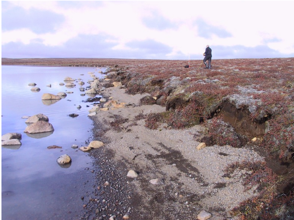
12. mynd. Niðurfallið torf og ummerki um öldurof á sniði R 12 í norðausturhluta lónsins í Galtarárflóa. Á sniðinu gekk bakkinn inn um 0,43 m sumarið 2006 en áður hafði lítið rof mælst á sniðinu. Fínöl hefur hlaðist upp í fjöruna og grjót úr jökulruðningi úr undirlagi myndar smám saman vörn gegn öldurofi úr bakkanum. Ljós. O.K.V. 25. september 2006, lón á yfirfalli.
